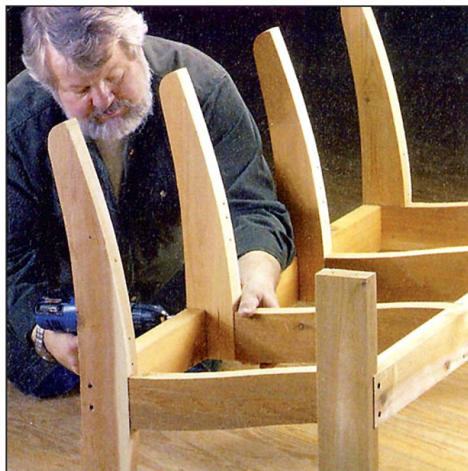
Каркас скамейки собирают из двух боковых и двух промежуточных подборок, соединив их передней и задней перемычками.
