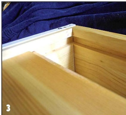
Для крепления днища ящика в боковых и передней стенках выбирал пазы, а у днища по трём соответствующим сторонам — четверти.
