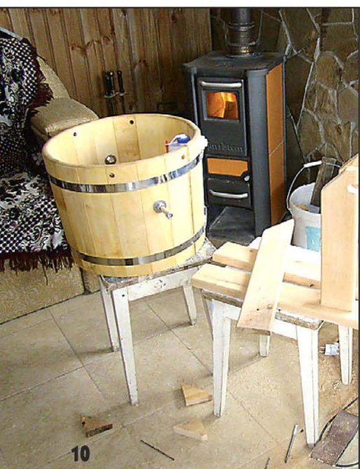
10 Кронштейны для обливного ведра изготовил из обрезков ольховых досок.
